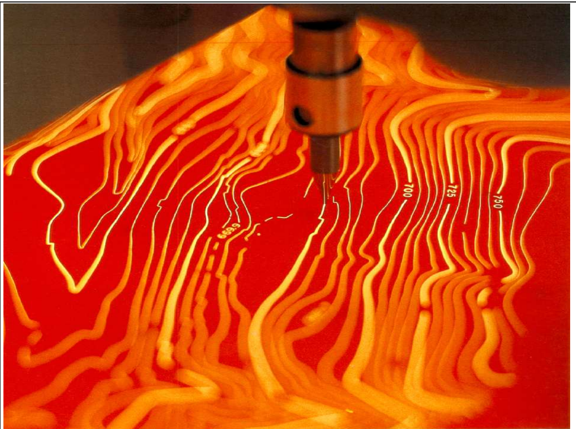
Εικ. Α.1.4. Η γραφίδα - πενάκι του plotter (σχεδιογράφου), όπως κινείται στην κόκκινη επιφάνεια του χαρτιού, χαράζοντας ισοϋψείς καμπύλες.
